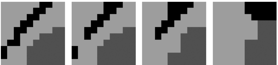
Figure 6. Final results of the optimisation using different values for \beta . Far left : \beta=1 ; left : \beta=3 ; right : \beta=5 ; far right : \beta=10 .
