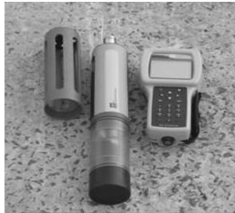
Figura 5 —Sonda Multiparâmetros de Monitoramento de Qualidade da Água YSI 6820.
