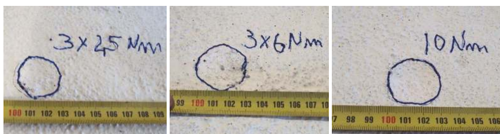
Figura 9. Deformações do impacto do corpo rígido para diferentes energias de impacto
