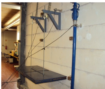
Figura 6. Esquema ensaio - compressão excêntrica
