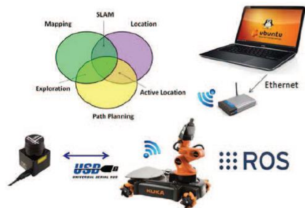
Figura 13. Esquema de arquitectura de control propuesta por (Schueftan 2015) [60]
