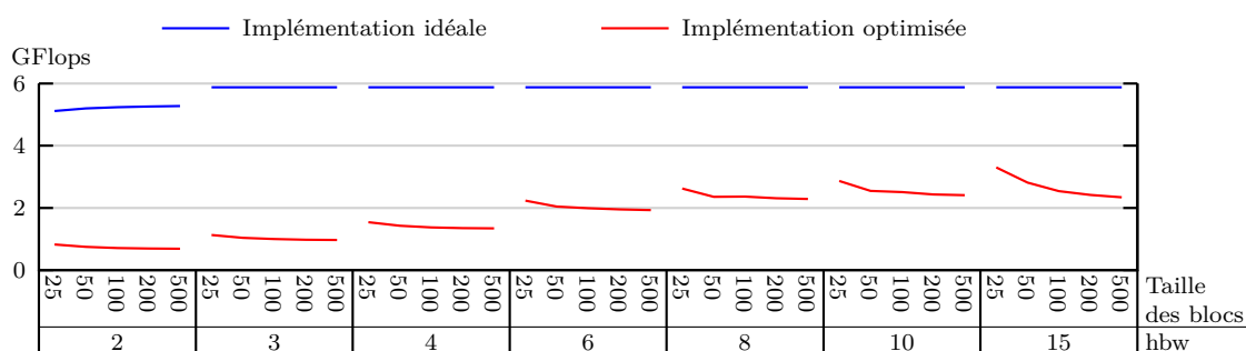
Figure 6.8 : Performances de l'implémentation optimisée sur 1 \times 4 SandyBridge (exécution séquentielle).
