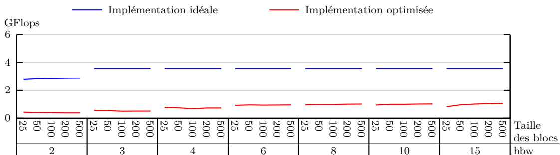
Figure 6.7 : Performances de l'implémentation optimisée sur 2 \times 4^{32} Nehalem (exécution séquentielle).
