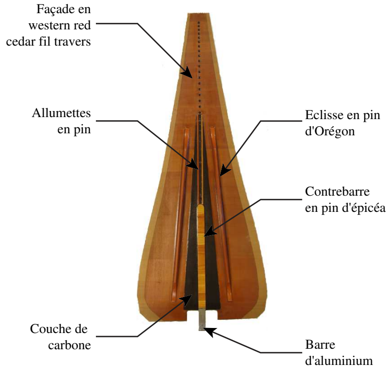
FIG. 1.6 – Description de la table d'harmonie de la harpe de concert Atlantide modèle Prestige.
