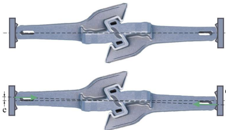
Рис. 2. Передача автозчепленням поздовжнього зусилля з ексцентриситетом
