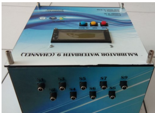
Fig. 6. Box calibrator waterbath desain
